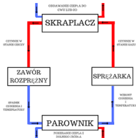
Rys. 1. Struktura budowy pompy ciepła. Źródło: https://www.google.com/search
