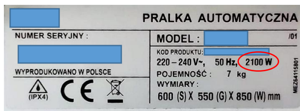
Rys. 1. Tabliczka znamionowa pralki wraz z jej mocą znamionową.
